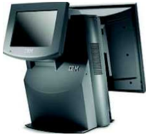
A képen: A különálló ügyfélképernyő (6.5-ös VGA LCD) információkat, illetve digitális multimédiás reklámokat jeleníthet meg a vevők számára (opcionális)
